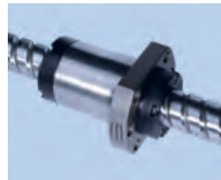
■ Baureihe 2426: Flanschmutter mit Stirndeckel, zweigängig, Vorspannung mittels Kugelübermaß
