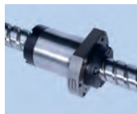
■ Baureihe 2526: Flanschmutter mit Stirndeckel, zweigängig, Vorspannung mittels Teilungsversatz
