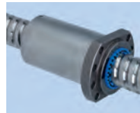
■ Baureihe 3526: Flanschmutter mit Gesamt- umlenkung, zweigängig, Vorspannung mittels Teilungsversatz
