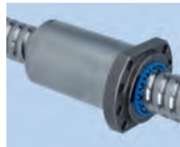
■ Baureihe 3426: Flanschmutter mit Gesamtumlenkung, zweigängig, Vorspannung mittels Kugelübermaß
