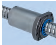
■ Baureihe 3416: Flanschmutter mit Gesamtumlenkung, eingängig, Vorspannung mittels Kugelübermaß
