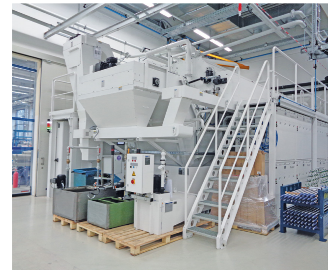
Mit unserer neuen Ölanlage erreichen wir beim Schleifprozess einen höheren Qualitätsstandard.
